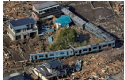
津波の直撃を受けた脱線し民家に衝突した JR 仙石線乗り車両
